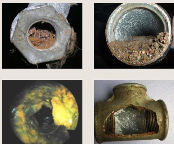
Fig. 3 : Dépôts, colmatage, gel, développement microbien... nuisent au bon fonctionnement des installations de sprinklage.
